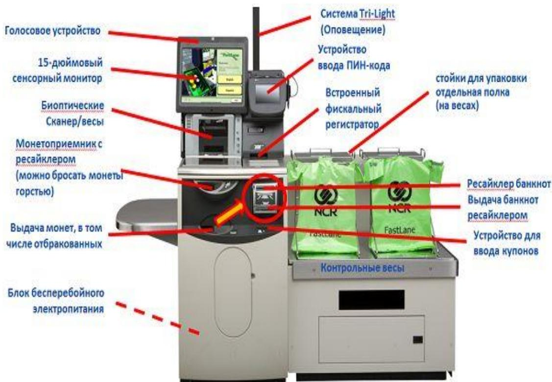
Рис.1 – Модель КСО с устройством приема и выдачи денег в виде купюр или монет
