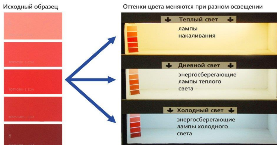
Рис. 7. Бокс, применяемый для просмотра цвета при различном освещении
