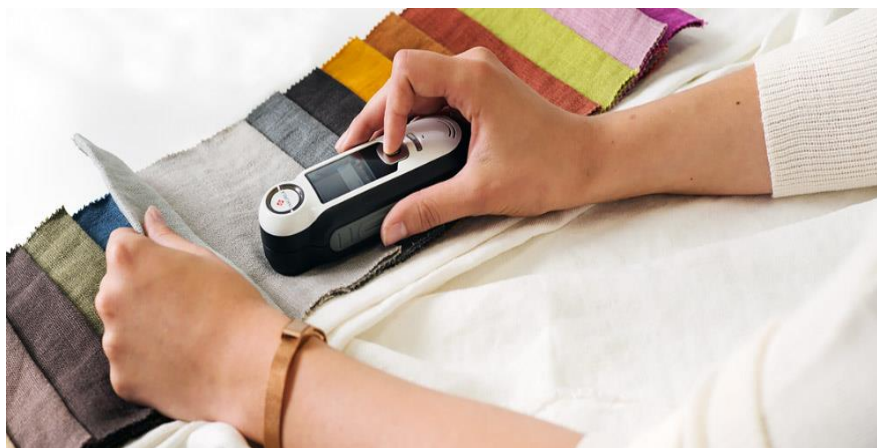
Рис. 6. X-Rite CAPSURE считывающее устройство цвета
